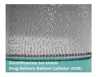
Neben dem präzisen Laserschneiden von Implantaten, wie Stents und Herzklappenrahmen, ist eine von MeKo's Fachkompetenzen das Laserbohren von Mikrolöchern für Drug Delivery Balloon Catheter (DDB). Bohrungsdurchmesser ab 2 µm sind möglich. Dank dieser winzigen Löcher können DDB's ihre Medikamente direkt beim Dilatieren abgeben.
